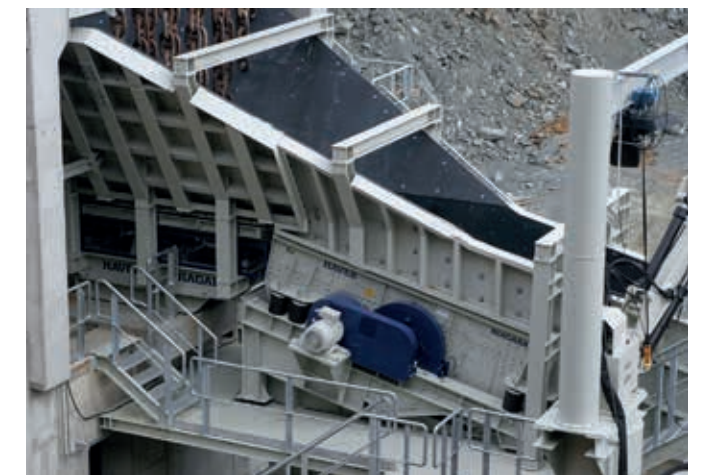
Robuste Bunkerkonstruktion über dem HAYER Schubwagen
