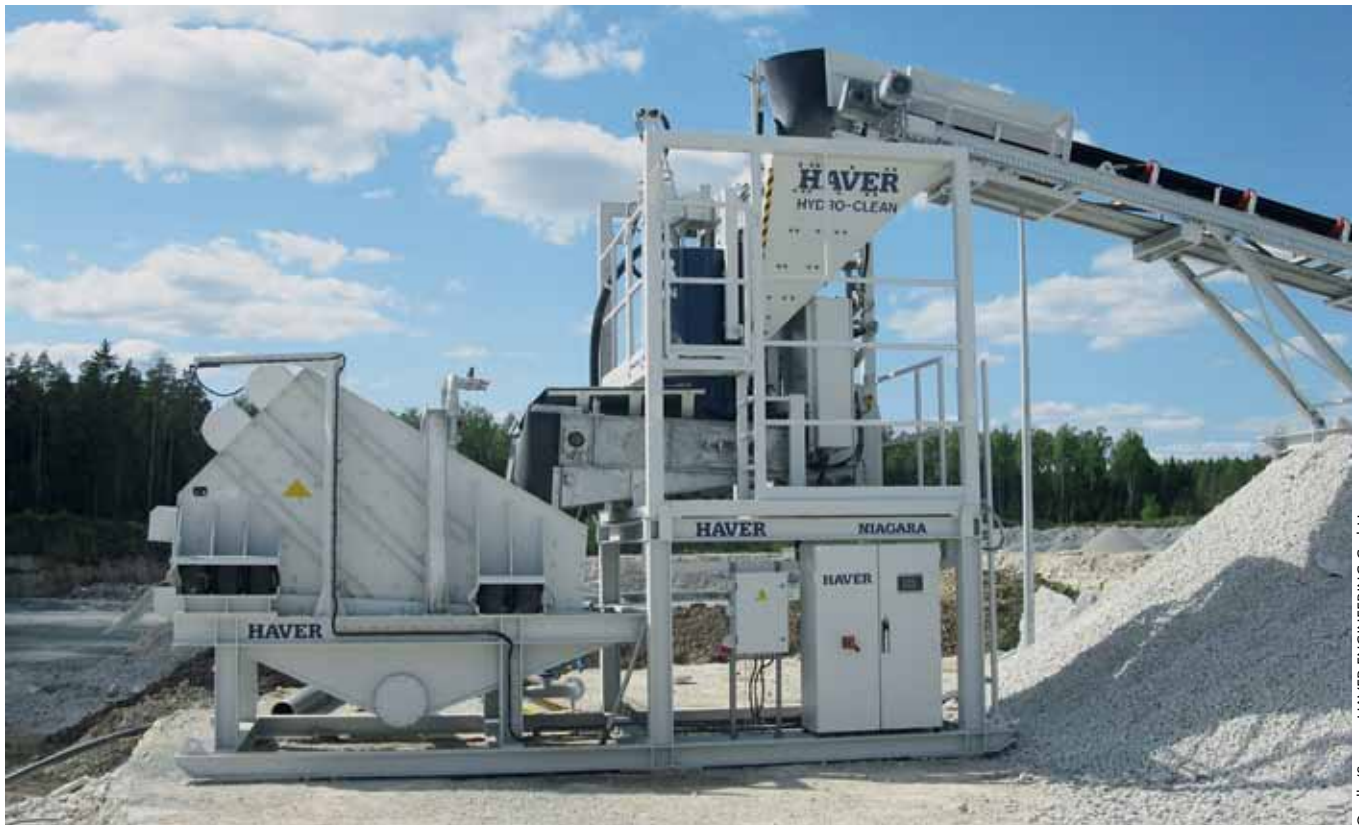
Der HAVER Hydro-Clean befreit mineralische Rohstoffe von unerwünschten Schad- bzw. Störstoffen HAVER Hydro-Clean removes contaminants/impurities from mineral resources
