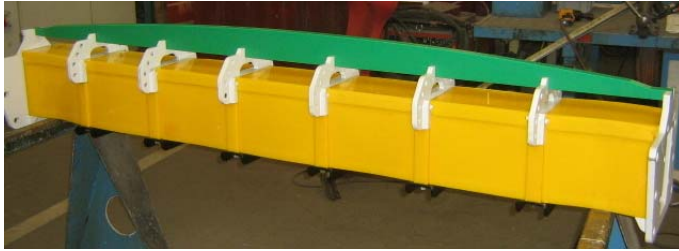
Bild 1: Traverse für Seitenspannung mit HAVER® -Snap Guard-Verschleißschutz
