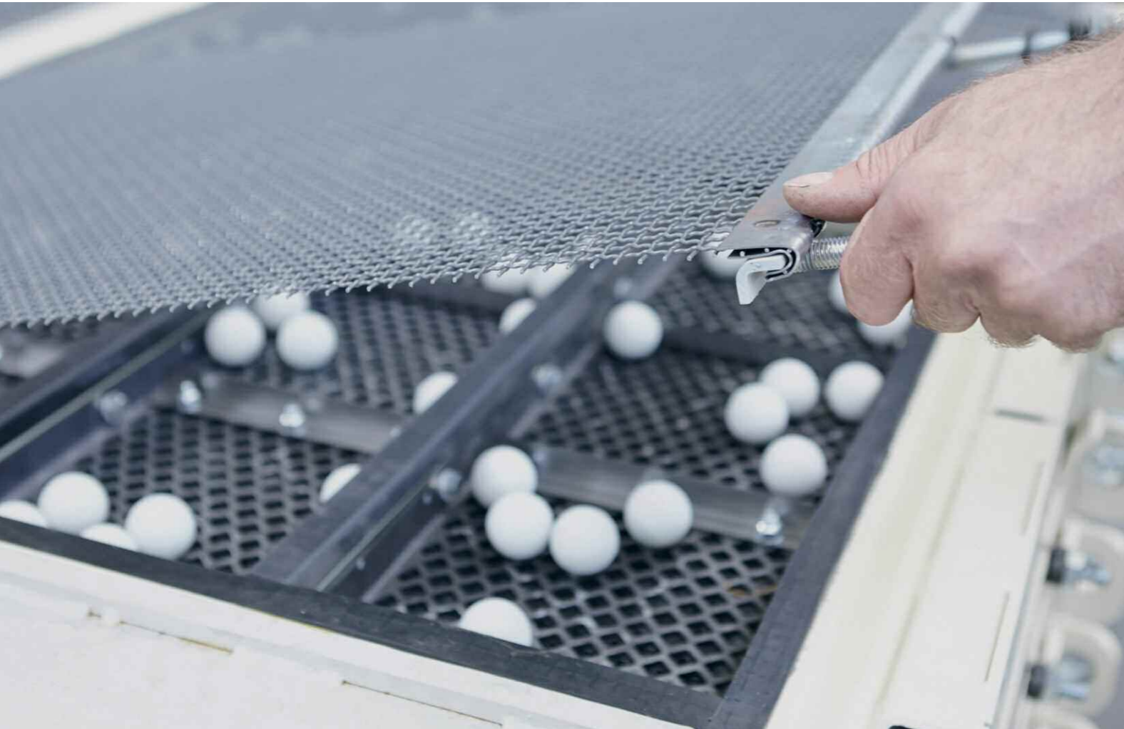
Unkomplizierter und partieller Austausch der Siebgewebe
