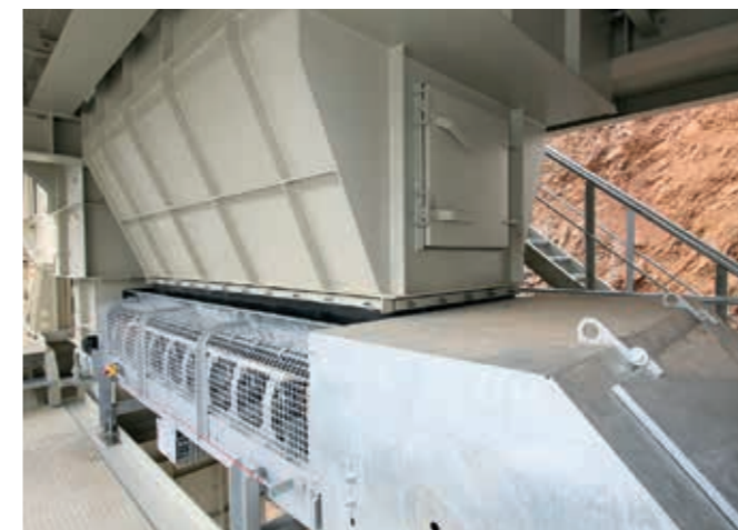
Wartungsfreundlicher Trichter über einem Gurtförderer
