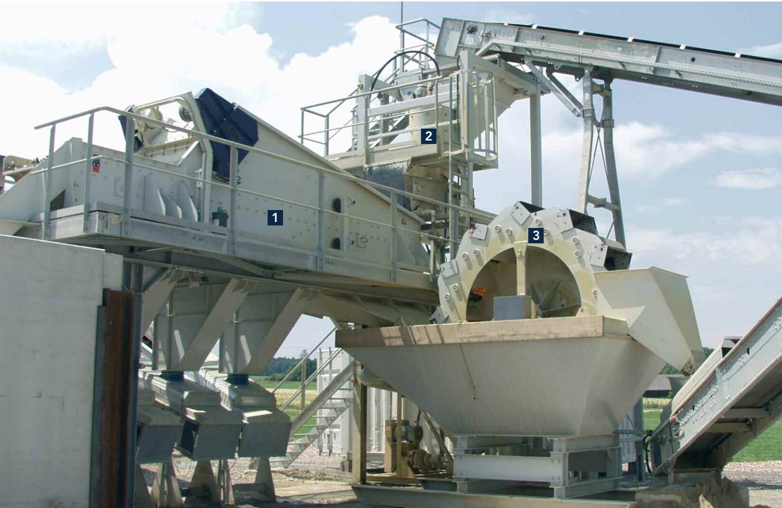
Anlagentechnik auf engstem Raum: 1 Klassiersieb – 2 HYDRO-CLEAN® – 3 Schöpfrad
