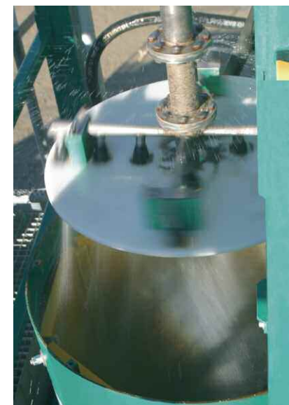
Waschrotor mit rotierenden Hochdruckwasserstrahlen
