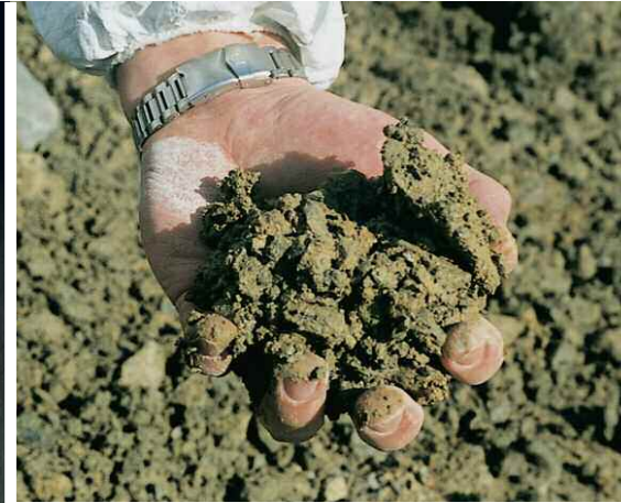
Vorher: bindiges Rohmaterial mit anhaftenden Feinanteilen und Agglomeraten
