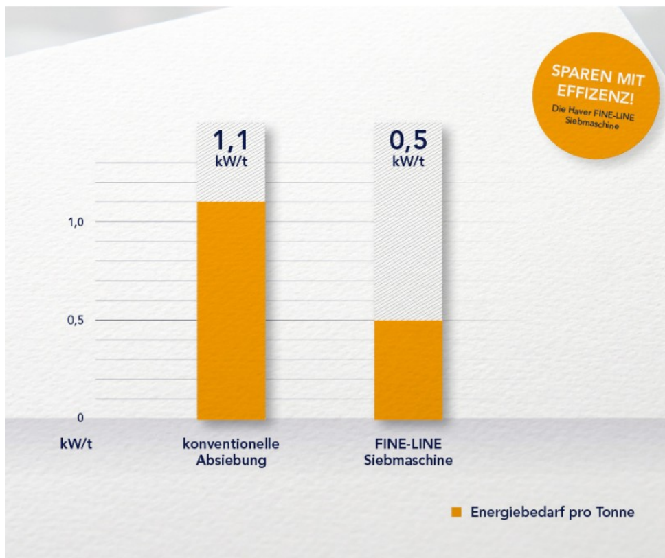
Energiebedarf; konventionelle Absiebung zur FINE-LINE Siebmaschine
